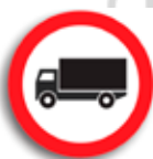
C7 – Accesul interzis vehiculelor destinate transportului de mărfuri
